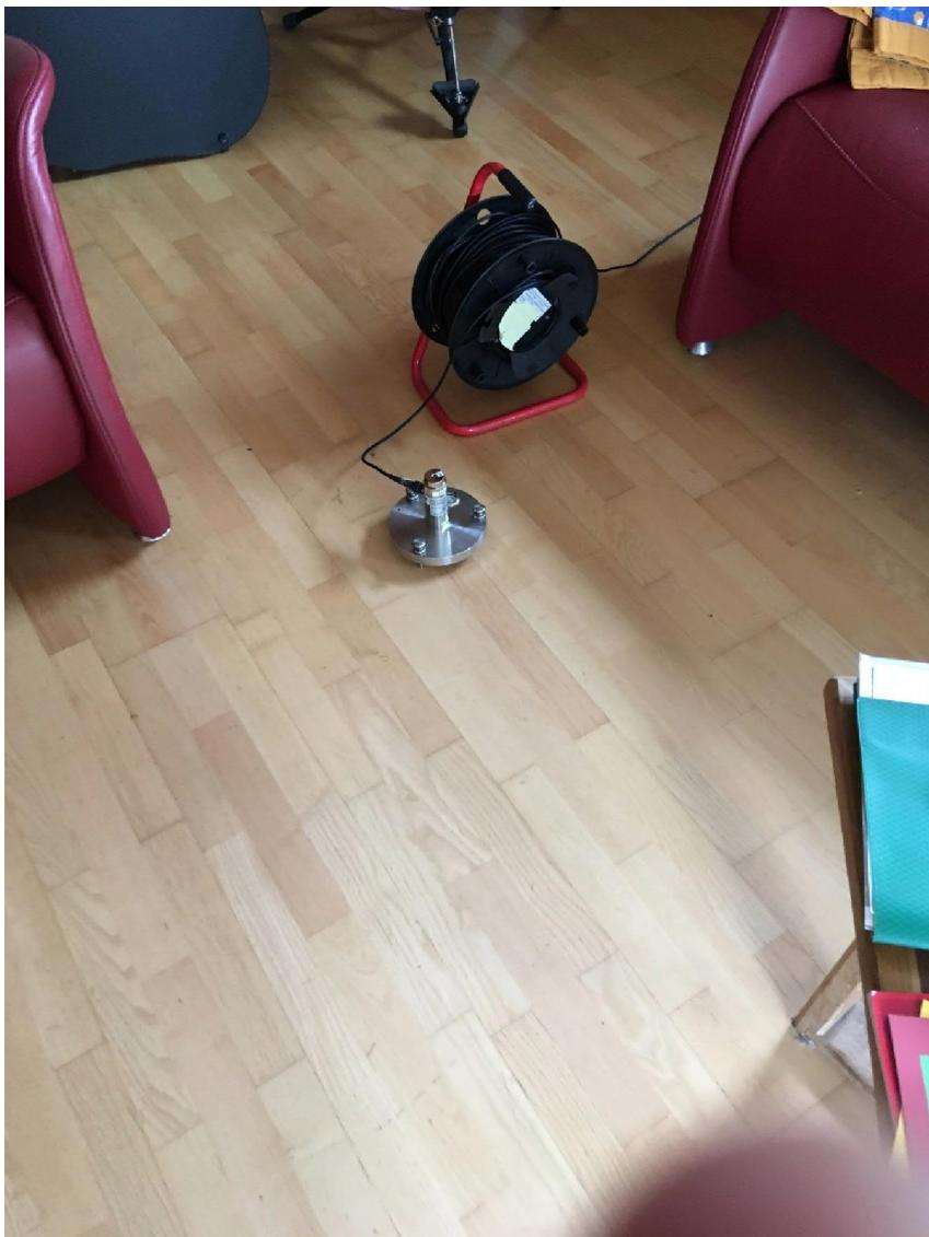
Messpunkt MP 6, Messung auf dem Ausbreitungsweg, Messpunkt Abstand zum Gleis ca. 8 m
